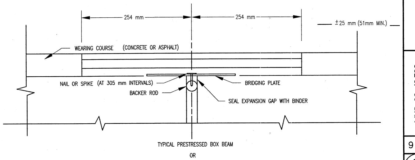
CONCRETE SLAB JOINT
