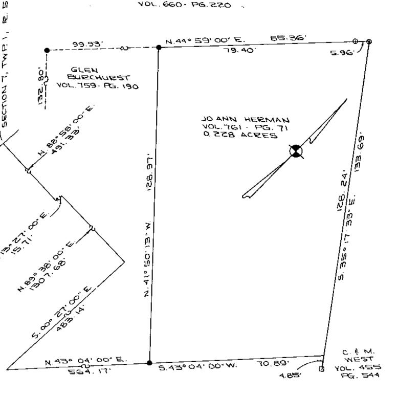
BEARINGS ARE BASED ON PREVIOUS SURVEY RECORDED IN VOL. GGO- PG. 220
